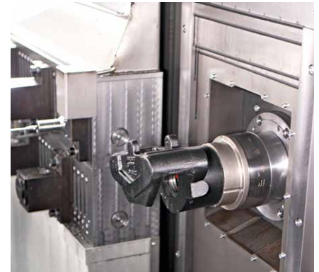
Werkstück auf Spanndorn OP 20 zur rückseitigen Bearbeitung
