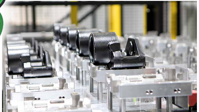
30 Teile Autarkie – Zuführband als Palettenstauband
