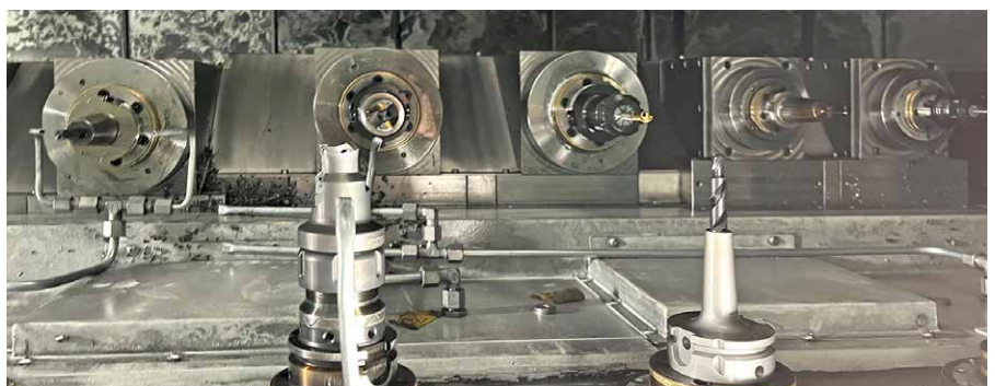
15 angetriebene Werkzeuge in OP20
