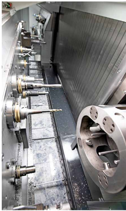
5 angetriebene Werkzeuge in OP10
