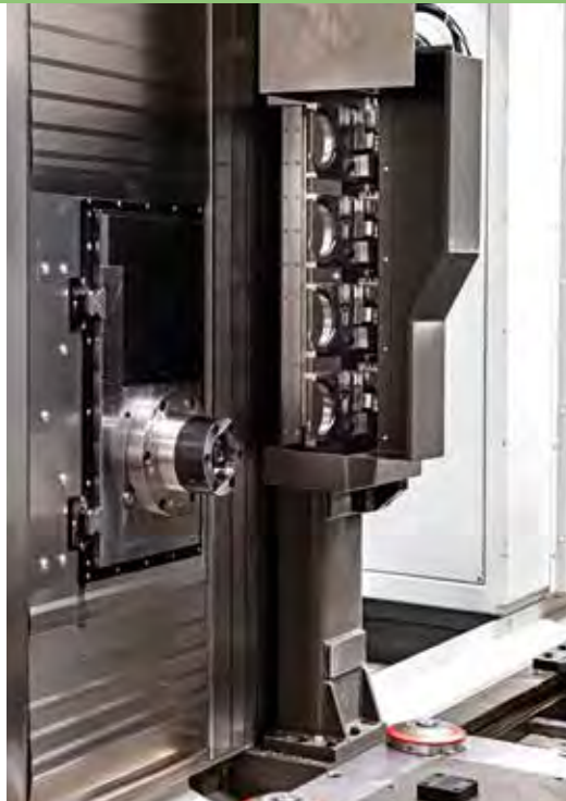
Die Anlage verfügt über sechs Drehspindeln
