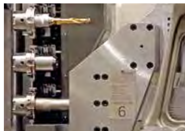
Werkzeugwechsel, 4-fach je Spindel
