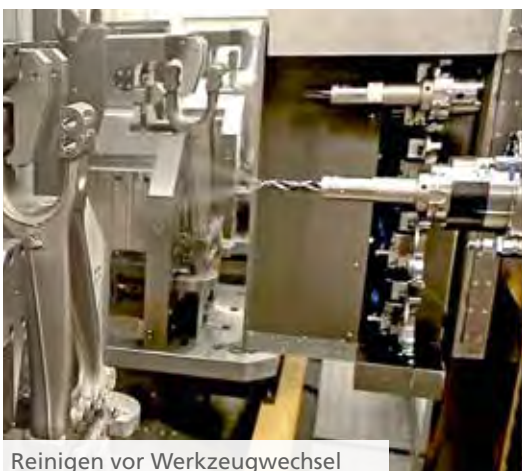
Beidseitige Bearbeitung – zeitgleich an drei Bearbeitungsstationen
