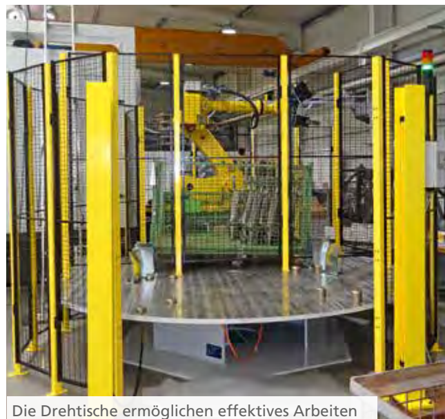
Fanuc-Roboter zum Be- und Entladen
