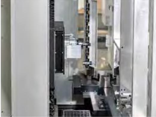
Der Arbeitsraum mit Fahrständer (links vorne), Fräskopf und Werkzeugspeicher (hinten)
