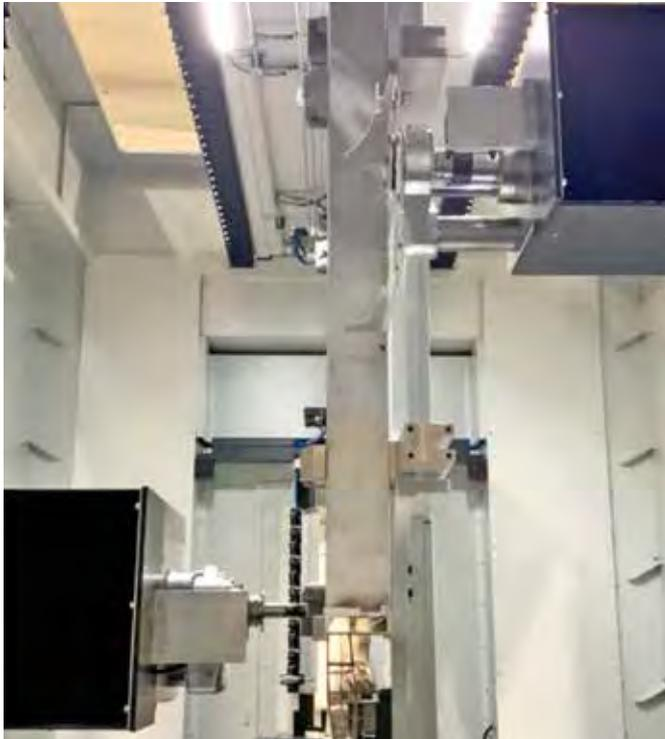
Frässpindel links und Frässpindel rechts (unter Absaugglocke) simultan an zwei Seiten im Einsatz
