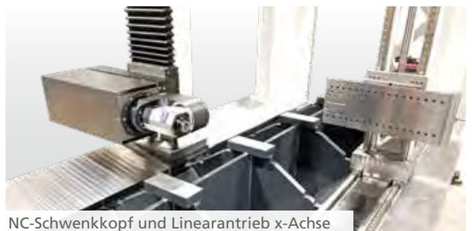
NC-Schwenkkopf und Linearantrieb x-Achse
