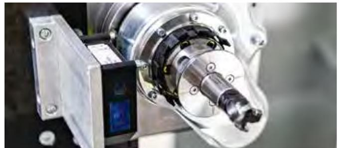
Wegsensor und Frässpindel mit eingefahrener Absaugglocke
