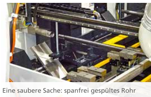
Rohre im Hub-Senk-Förderer zur Übergabe an Kraftspannblöcke
