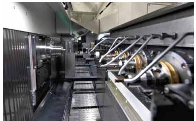
OP10: 8-fach Werkzeugträger, davon vier angetrieben
