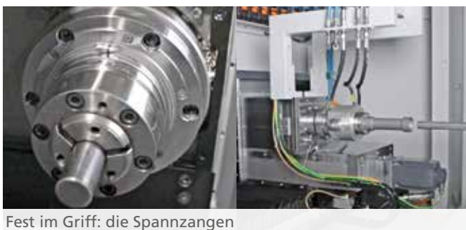
OP20: 8-fach Werkzeugträger, davon ein angetriebenes
