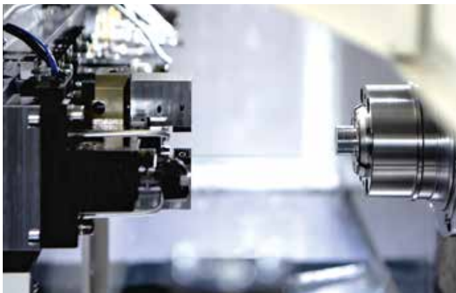
Pneumatischer Greifer (links) und Durchlass-Spannzange Spindel OP10 mit Stange (rechts)
