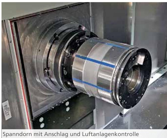
Spanndorn mit Anschlag und Luftanlagenkontrolle
