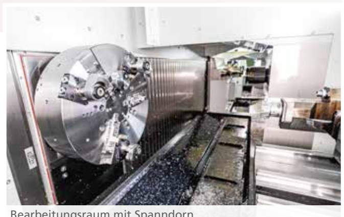
Bearbeitungsraum mit Spanndorn
