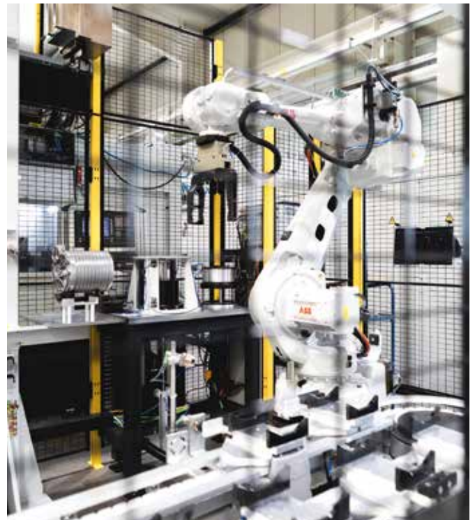
Messstation mit Handlingsroboter
